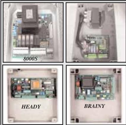
**8000S** : Coffret de commande universel pour 2 moteurs 220v .Modèle standard.(sans récepteur).
