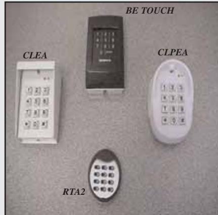
**Claviers à codes radios 433 mhz à code variable :**
