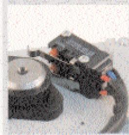
Fins de courses électromécaniques d'ouverture et de fermeture incorporés
